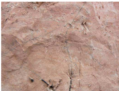
Рис. 4.3. Линии раздела отдельных мергелистых блоков и окраска скола породы по линии раздела с глубины 700-730 см.
