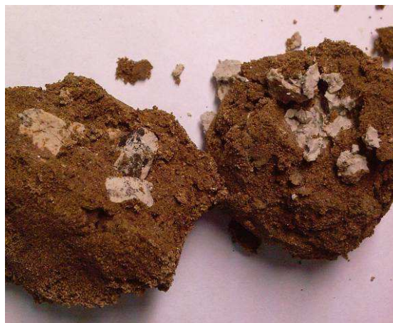
Рис. 4.16. Новообразования гипса в породе с глубины 1300 см.
