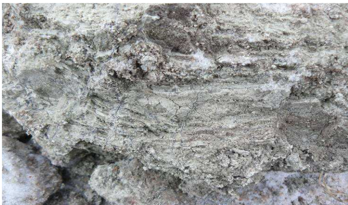
Рис. 4.2. Образец выщелоченного известняка с глубины 500-700 см.
