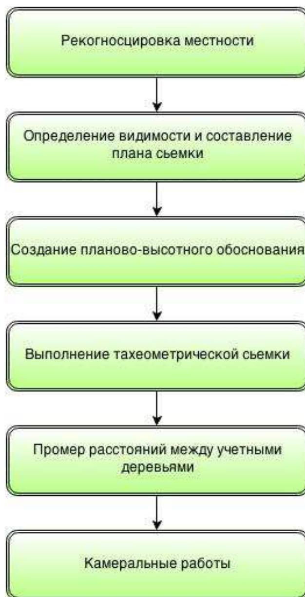
Рис. 3.1. Последовательность создания картографо-геодезической основы пробных площадей.
